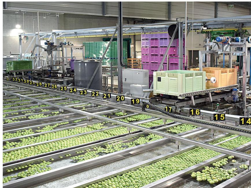
Du pré-calibrage à la filtration en circuit fermé, chaque pomme est analysée trois fois, pesée et passée à la loupe des scanners sous 30 angles différents.
